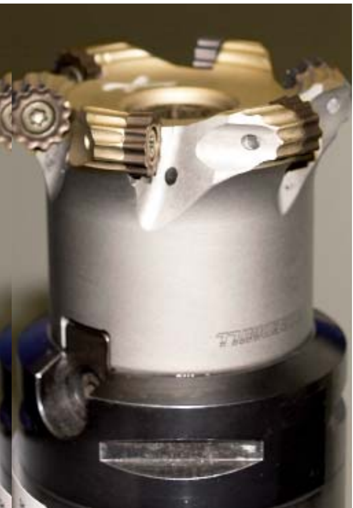
1 Werkzeugvoreinstellung des Millshred-Fräasers bei DMR – deutlich zu sehen ist die segmentierte Schneidengeometrie der Fräsplatte auf dem Monitor des optischen Messgerätes. 2 Millshred-Schrupfräser von Iscar: die segmentierte Schneidengeometrie ermöglicht ein prozesssicheres Fräsen in tiefen Kavitäten bei hohen Schnittwerten. 3 Michael Bender (links), Industriespezialist Power Generation bei der Iscar Germany GmbH, Helfried Waldschläger (Mitte), Werkzeugwirtschaft/Instandhaltung bei der DMR Produktionsgesellschaft, und Andreas Meier (rechts), Beratung & Verkauf bei der Iscar Germany GmbH.
